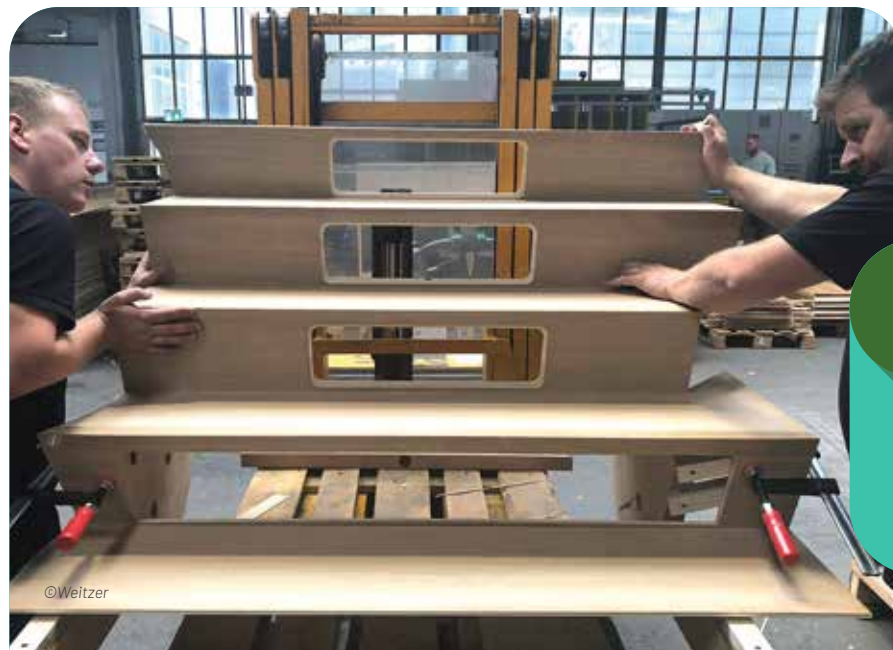
Demonstratorbau einer Bustreppe aus Holz bei Weitzer Parkett
