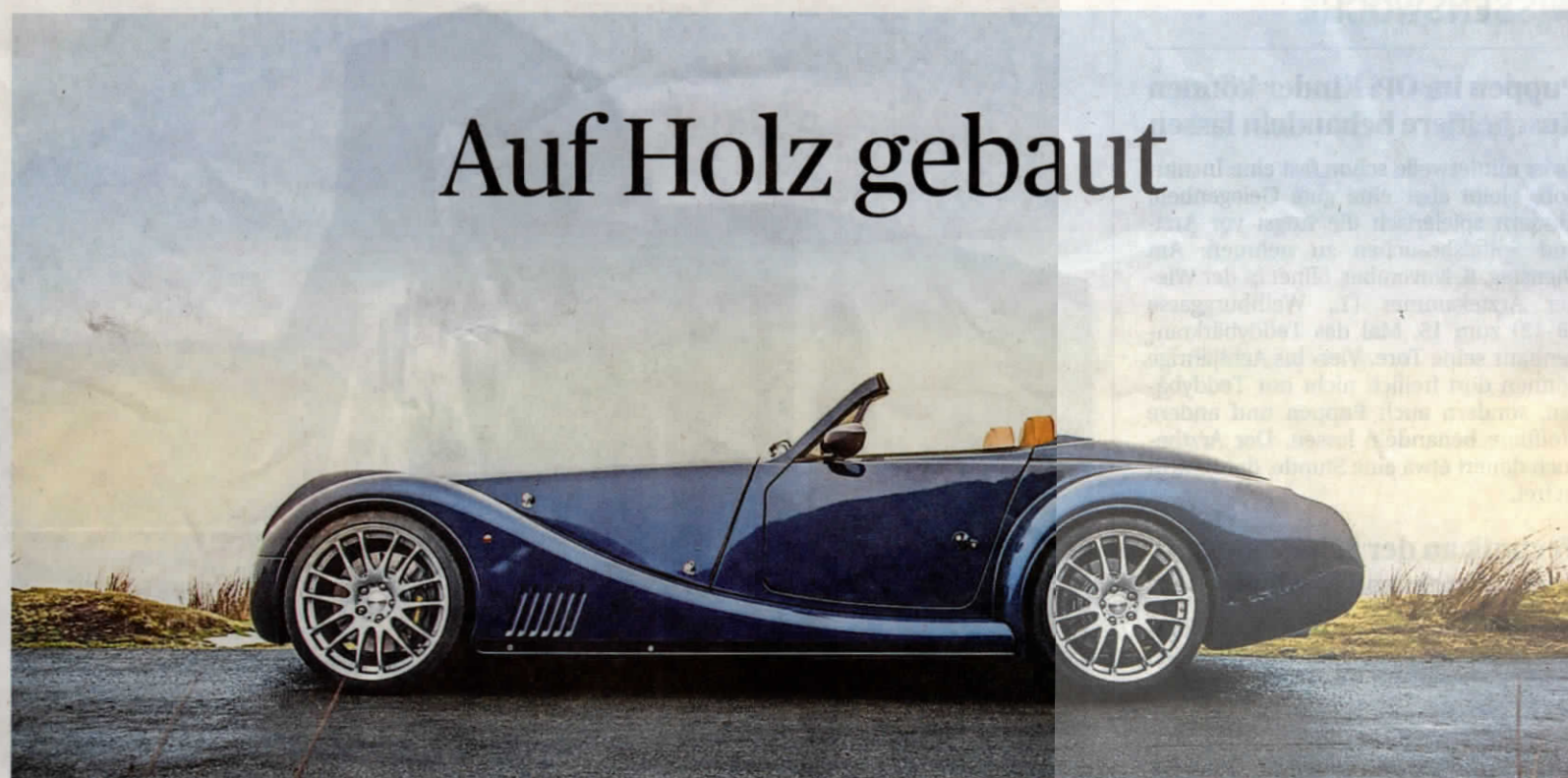
Morgan-Sportwagen wie der Aero 8 haben ein Gerüst aus Eschenholz. Boku-Forscher planen nun Rücksitzwand, Unterboden und Armaturenräger aus Holz.
