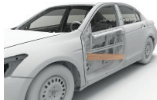
Renderin des Seitenaufprallträgers in der Einbausituation. Foto: @WoodC.A.R./NHTSA
