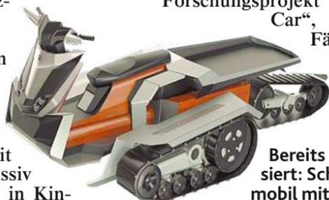
Bereits realisiert: Schneemobil mit tragendem Kern aus Holz.
