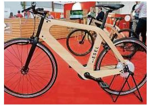
**Holz-Drahtesel** konfiguriert und produziert die Linzer Firma „My Esel“. Ein Algorithmus ermöglicht anhand von Körpergröße und Unterschenklänge Maßfertigung: wasserfest und holzwurmsicher.
