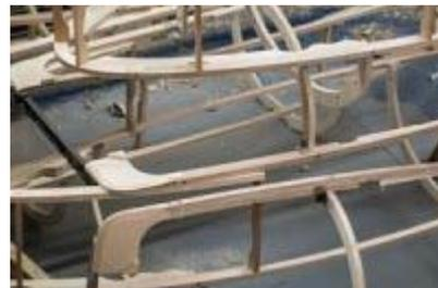
**Bilder:** Handgefertigte Holzrahmen für die Sportwagen von Morgan. Oben: Der Morgan Plus 8, bei dem die Rahmen aufregend verbaut sind.
