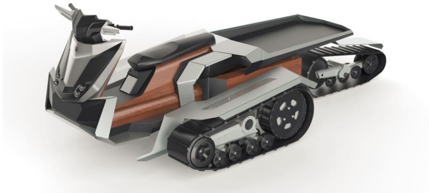
Abb. I-7: Elektrisch betriebenes Schneefahrzeug Ardener der Fa. MATTRO mit Tragstrukturen aus Holzverbundwerkstoffen (3D Ansicht).
