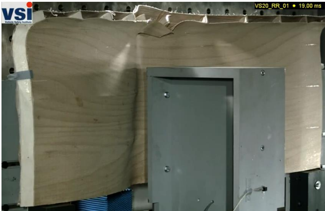
Abb. I-5: Prüfstands Aufbau für Holz-Crashversuche. Die Abbildung zeigt das Eindringen des Impaktors in eine Rückenlehne.
