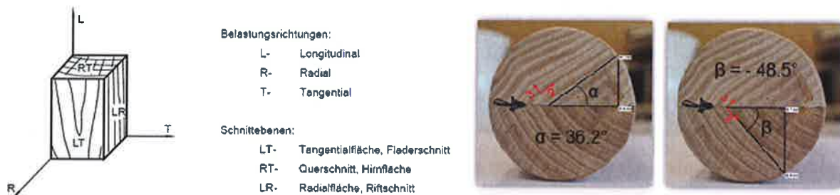
Abb 3: Koordinatensystem Vollholz links [Niemz, P.; 2011], Faserwinkel an verlebtem Vollholz Rundstab (Durchmesser 60 mm).
