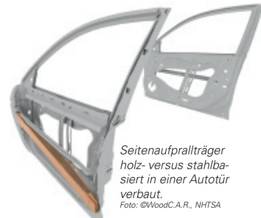
*Seitenaufprallträger holz- versus stahlbasiert in einer Autotür verbaut.
