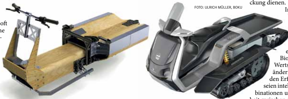
Holz statt Stahl: Bei diesem Schneemobil namens Mattro wurde der Rahmen komplett aus Holz gebaut – das hat 140 kg Gewicht eingespart.
